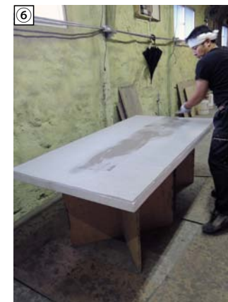
⑥ 左官職人が1枚1枚手作業でベースコートとグラスファイバーメッシュを施工
