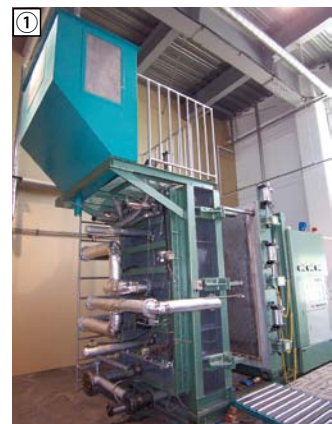
① 100×200×50cmのEPSブロックを1時間に10本作ることができる第二工場の成型機
