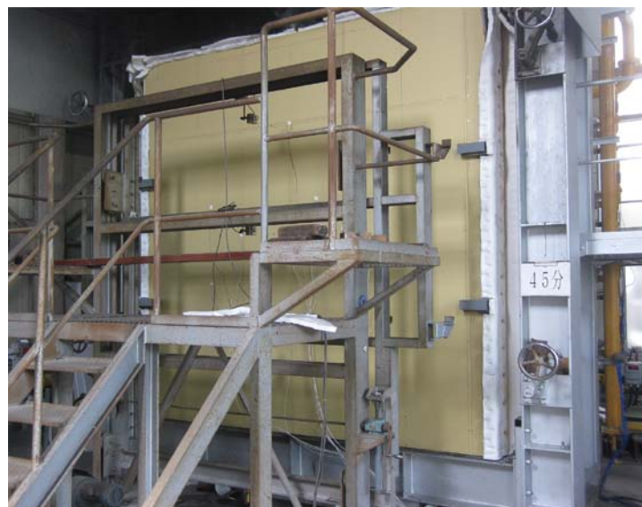
外壁面(トップコート側)から火を当て続け45分経過した後の「DAN壁」試験体。手前に見えるのが室内側の石膏ボード
