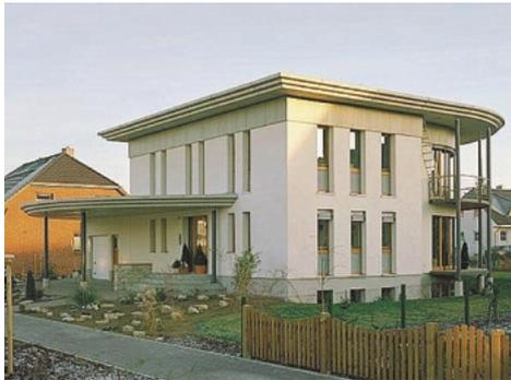
ドイツに建てられたパッシブハウス。シュトーターサーモクラシックによる外壁300 mm断熱を採用している
