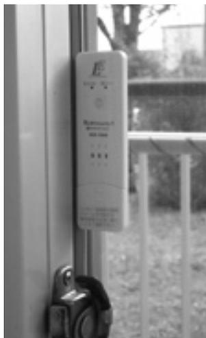
写真1・窓ガラスの錠の近くに取付けた振動ブザー
