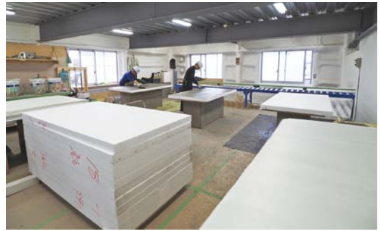
最大3人の職人でEPSにベースコートを塗り、グラスファイバーメッシュを伏せ込む
