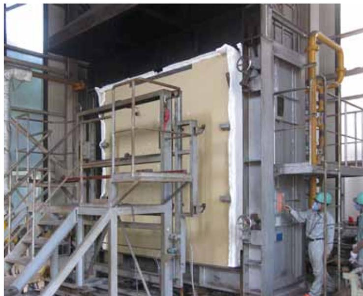
加熱装置に設置された「DAN壁」パネル
