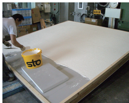
トップコートで仕上げを行っている試験体。試験ではトップコート側から火を当てて加熱することになる
