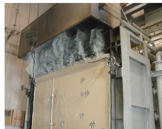
試験中の試験体。炭化している部分はあるものの、室内側への燃え抜けなど防火性能の判定基準はすべてクリアした
