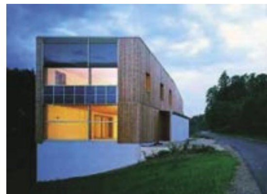
ドイツに建てられたパッシブハウス。太陽光を積極的に採り入れるための大開口部が大きな特徴
